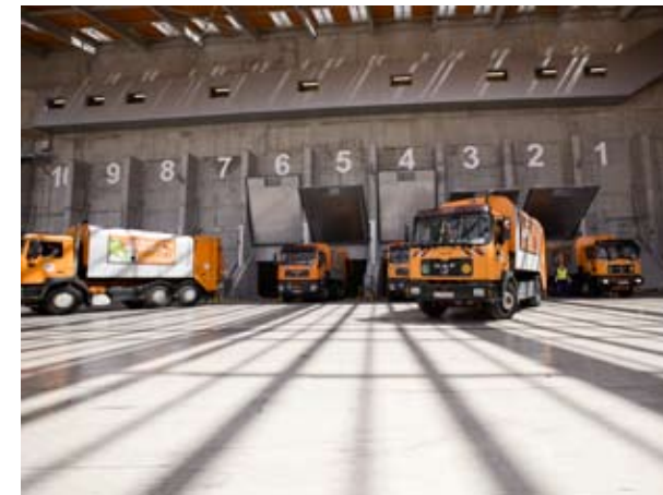
12 ABKIPPSTELLEN zur Entleerung 12 TILTING SPOTS for unloading
