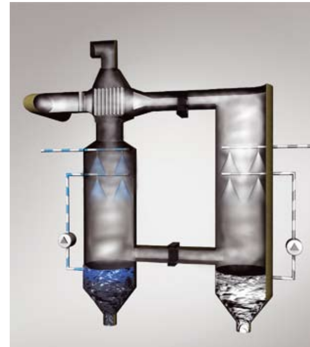
Schnittbild WÄSCHER Profile of WET SCRUBBER
