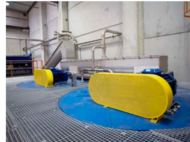
ANTRIEB DER RÜHRWERKE zur Vermischung des Wassers und der Abfälle ENGINE OF THE STIRRING DEVICES for the intermix of water and waste
