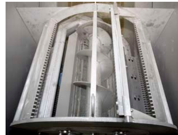
RECHENKORB mit umlaufender Harke RAKE CAGE with a revolving rake
