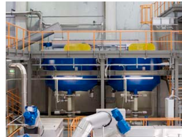
Die TURBOMIXER haben ein Nutzvolumen von je 10 m³ The TURBOMIXERS have a usable volume of 10 m³ each
